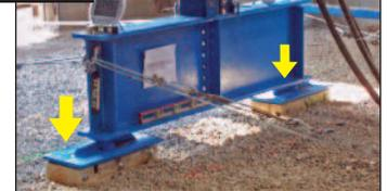
Aproximadamente 37 toneladas de força em um eixo único replicado com um bate-estacas hidráulico de alta capacidade
