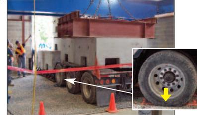
Teste com carga real utilizando um único eixo para concentrar o peso
